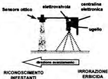
Figura 3. Schema della disposizione dei componenti nel diserbo a tratti con riconoscimento diretto delle infestanti
