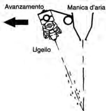
Figura 6. Schema di funzionamento di una barra aeroassistita
