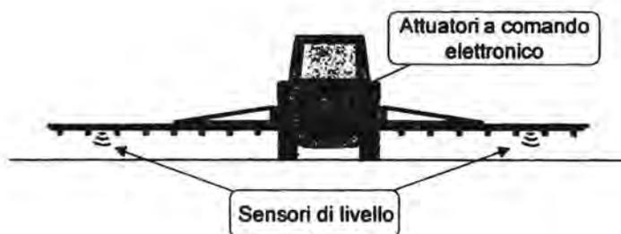
Figura 1. Schema di funzionamento del sistema di controllo automatico dell'altezza della barra
