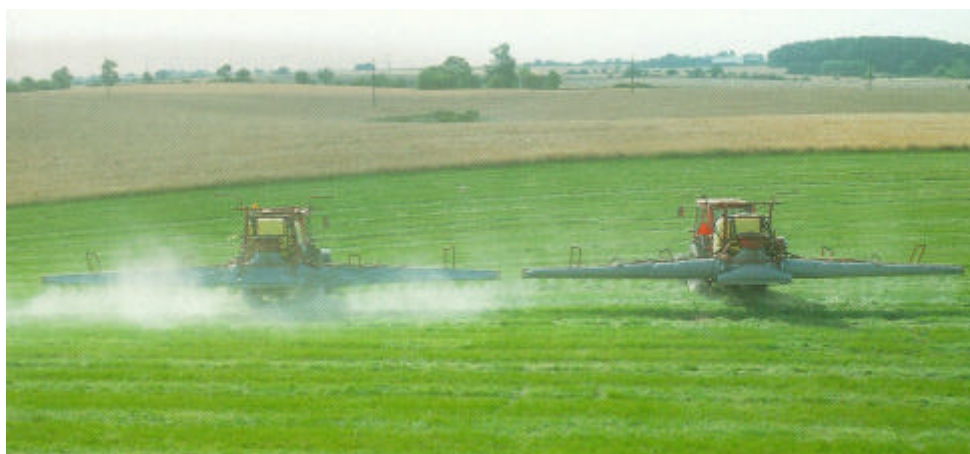
Figura 3 - Esempio di barra irroratrice dotata di manica d'aria: in funzione (a destra) e disattivata (a sinistra).
