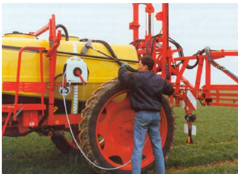
Figura 6 - Esempio di sistema per la pulizia esterna della macchina irroratrice da effettuarsi direttamente in campo
