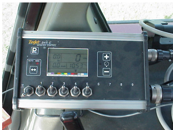
Fig. 5 – Esempio di pannello di controllo della distribuzione con display multifunzione.
