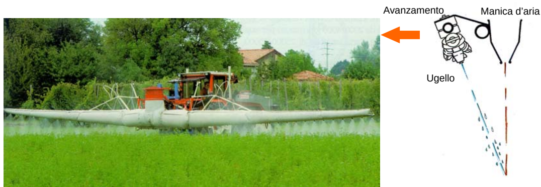
Fig. 4 –Barra irroratrice equipaggiata con manica d’aria e relativo schema di funzionamento.
