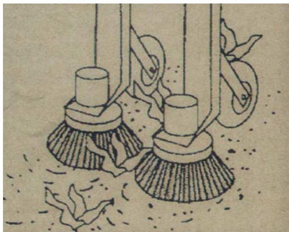
Figura 4. Schema di una spazzolatrice ad asse verticale.
