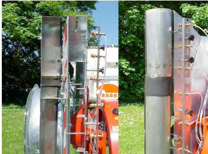
**Figura 8. Dispositivo per la chiusura della sezione di uscita dell'aria su un lato della macchina irroratrice.**
