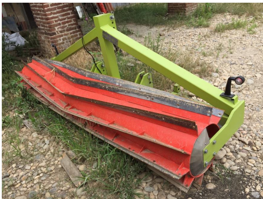
Figura 6. Rullo crimper, dotato di lame elicoidali. L'attrezzo nell'immagine è progettato per essere portato anteriormente dalla trattrice.
