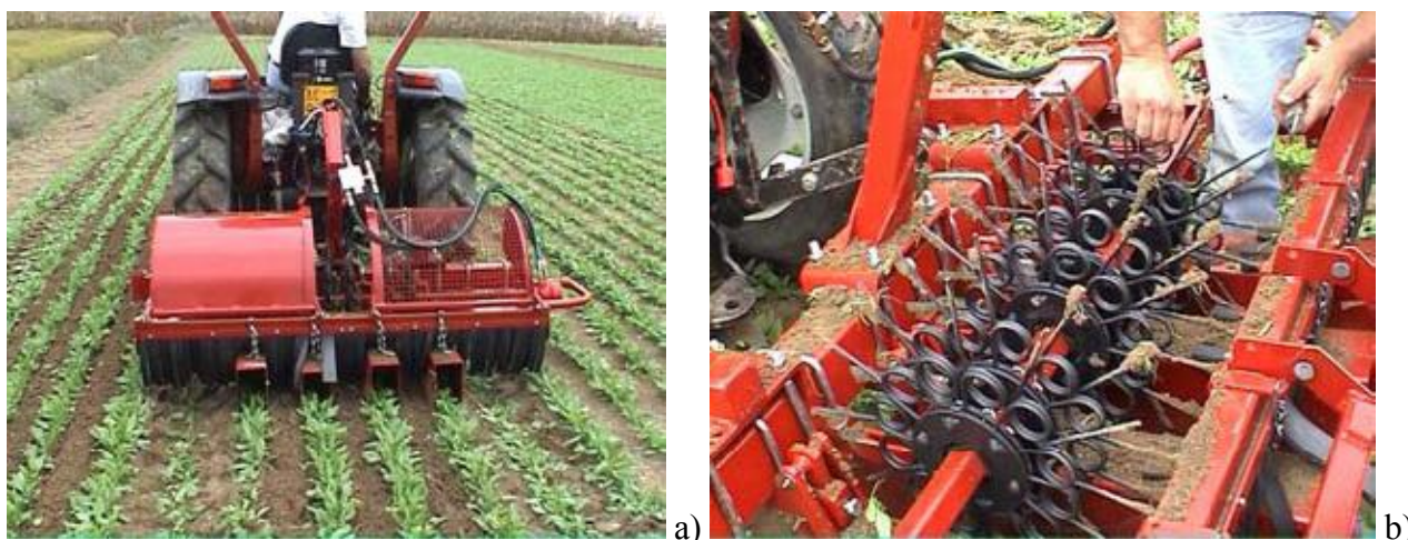
Figura 2. a) Sarchia-separatrice su spinacio (interfile di 25 cm): sono visibili i carter a protezione della coltura; b) fili di acciaio flessibili montati su flange rotanti a mo' di spazzola (da Tei et al, 2002a)
