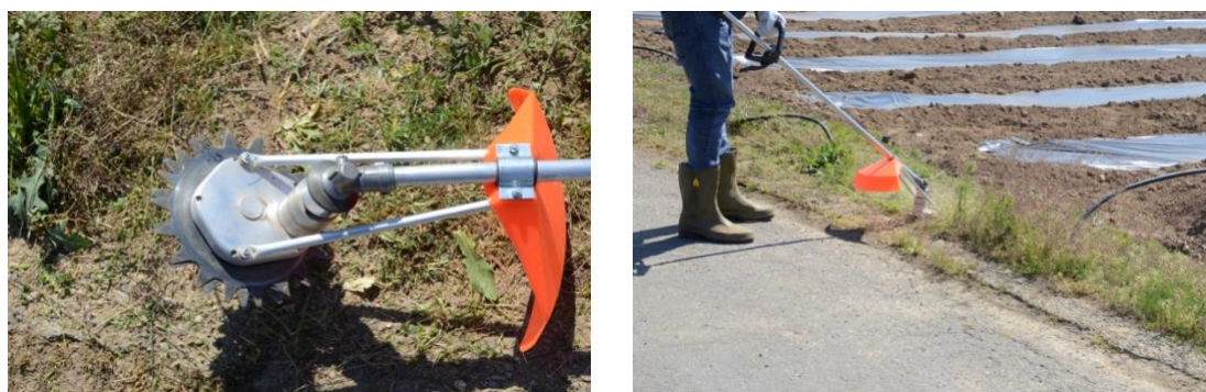
Figura 9. Decespugliatore dotato di testa di taglio reciprocante in azione su un bordo stradale. In questo modello i due dischi sono controrotanti (foto F. Vidotto).
