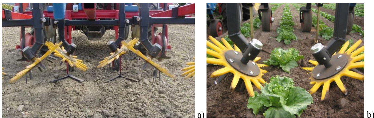
Figura 4. a) Finger-weeder: sono visibili gli elementi sarchianti a “zampa d’oca” e i piattelli con le dita gommate (da Pannacci e Tei, 2015); b) finger-weeder durante un trattamento su lattuga (fonte: Kress Umweltschonende Landtechnik).
