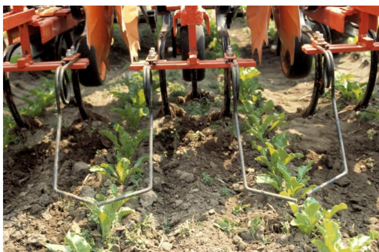
Figura 5. Diserbatore elastico o “torsion-weeder” (da Ascard et al., 2014).
