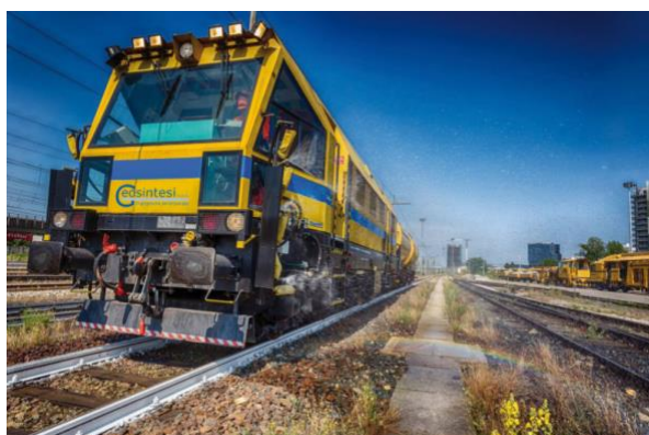
Figura 2. Treno diserbatore (a); mezzo strada rotaia (b).
