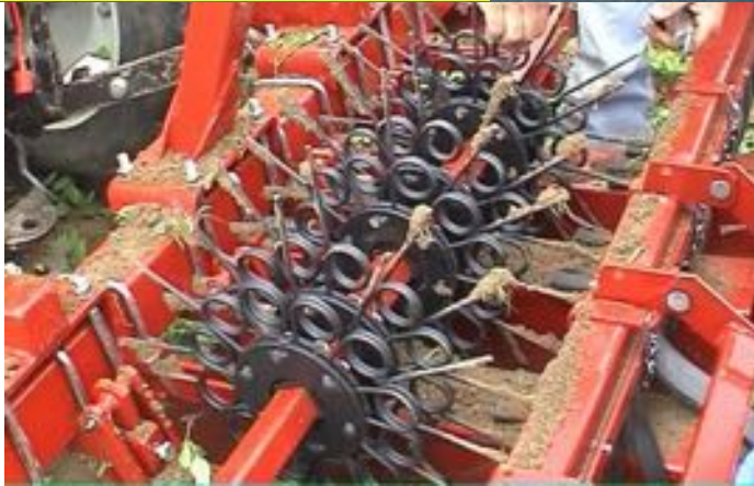
Zappette rigide ad ali orizzontali e fili di acciaio su flange rotanti
